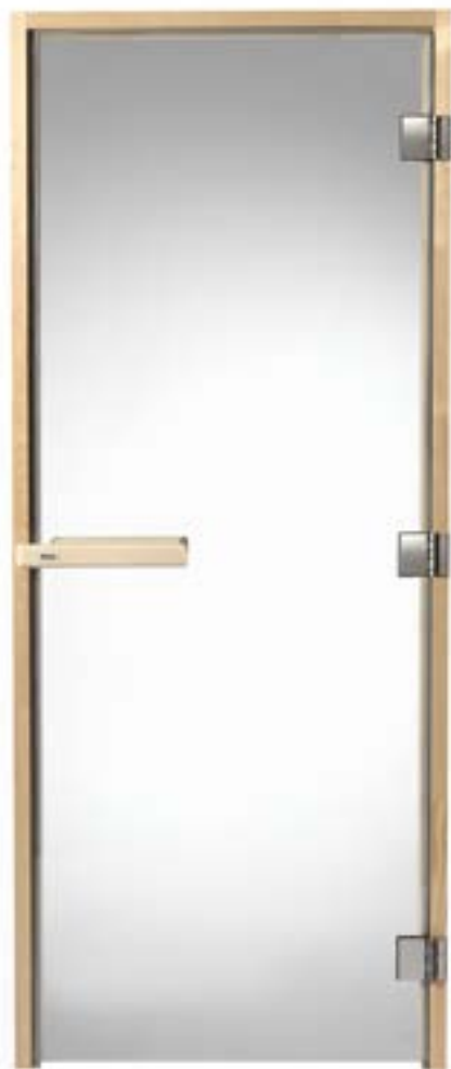
DGB Dörrblad i härdat 8 mm säkerhetsglas, bronsfärgat eller klarglas. Fingerskarvad karm (92 mm) i furu med tätningsslist i silikon. Dörrhandtag i asp, magnetlåsstängning.
