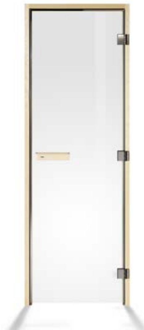
DGL Dörrblad i härdat 8 mm säkerhetsglas, bronsfärgat eller klarglas. Solid karm (92 mm) i asp med en egenutvecklad tätningslist. Mindre dörrhandtag, magnetliststängning.
