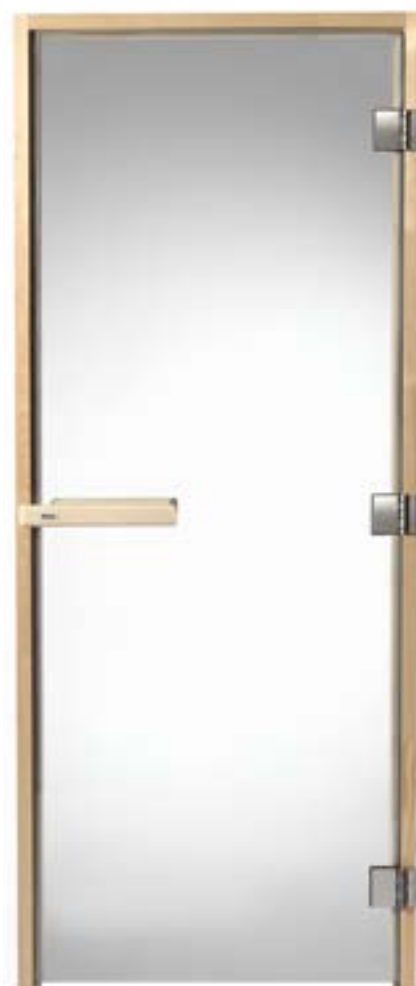
DGB Dörrblad i härdat 8 mm säkerhetsglas, bronsfärgat eller klarglas. Fingerskarvad karm (92 mm) i furu med tätningslist i silikon. Dörrhandtag i asp, magnetlåsstängning.
