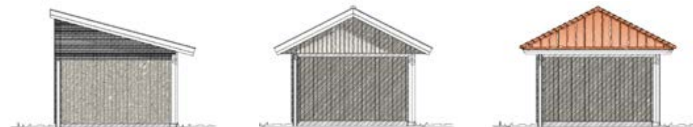
5. Pulpettak med raster 6. Sadeltak med inklädd takfot 7. Valmtak
