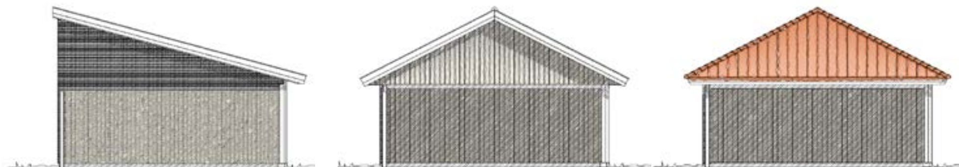
5. Pulpettak med raster 6. Sadeltak med inklädd takfot 7. Valmtak
