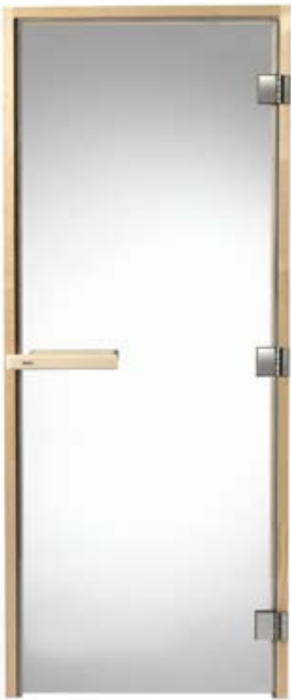
DGB Dörrblad i härdat 8 mm säkerhetsglas, bronsfärgat eller klarglas. Fingerskarvad karm (92 mm) i furu med tätningsslist i silikon. Dörrhandtag i asp, magnetlåsstängning.
