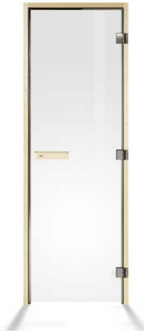
DGL Dörrblad i härdat 8 mm säkerhetsglas, bronsfärgat eller klarglas. Solid karm (92 mm) i asp med en egenutvecklad tätningsslist. Mindre dörrhandtag, magnetliststängning.
