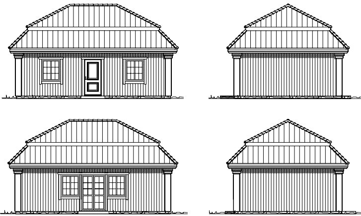
Sidobyggnad. Säljs med 145+70 mm tvåskiktsvägg inklusive isolering men exklusive inredning. Ovan visas ett förslag.
